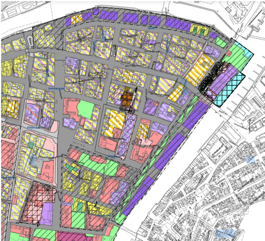
Status quo-kart for regulering i nordøstre del av Midtbyen. Samferdselsarealer vist med grå farge.
