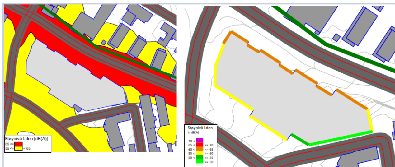
Figur 9. Støysonkart tomt 1B i delområde 1. Støynivå L_{den} på fasader og L_{den} -nivåer ved 1,5 m beregningshøyde for vurdering av uteoppholdsareal.
