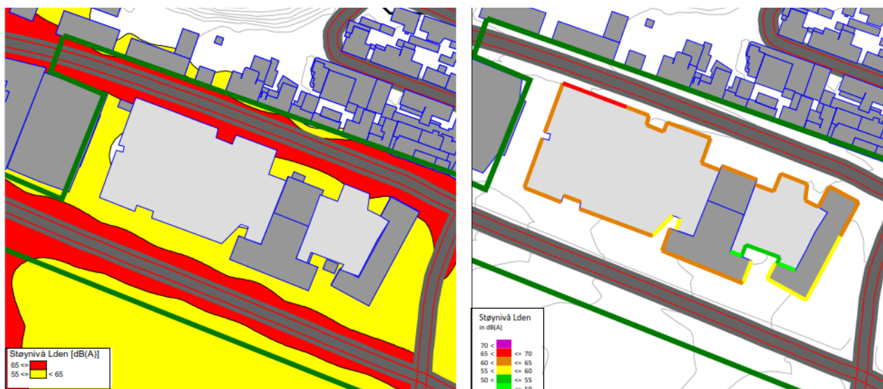
Figur 7. Støysonekart tomt 2 i delområde 1. og Støynivå L_{den} på fasader og L_{den} -nivåer ved 1,5 m beregningshøyde for vurdering av uteoppholdsareal.
