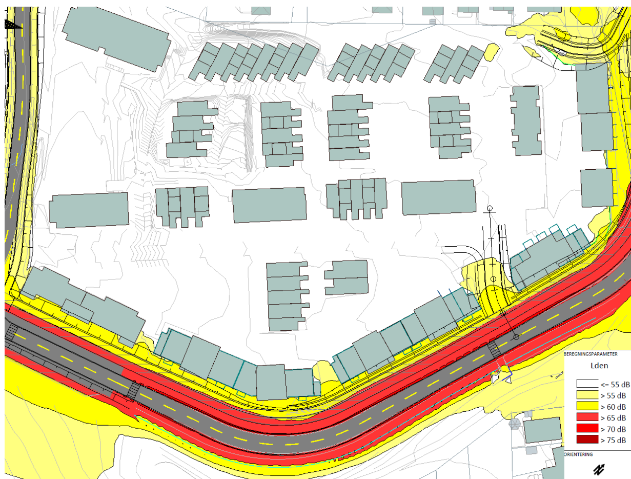
Figur 3 - Beregnet støy, L_{den} , på planområdet fra veitrafikk. Beregnet i høyde 1,5 m over terreng.
