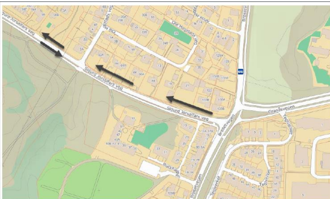
Figur 83: Delstrekning 2 (B) – envegsregulere Sigurd Jorsalfars veg for motorisert trafikk, vest for krysset med Brøsetvegen til Ole Hogstads veg. (Finn.no/kart)
