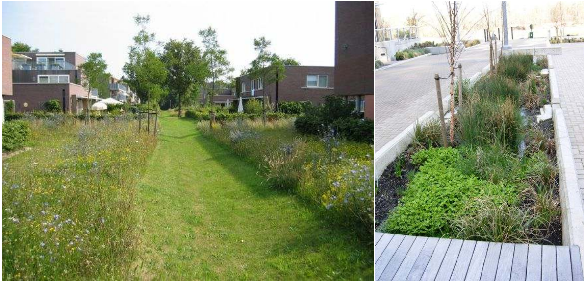
Figur 13 Eksempel nedsenket areal/gresskledd grøft og regnbed
