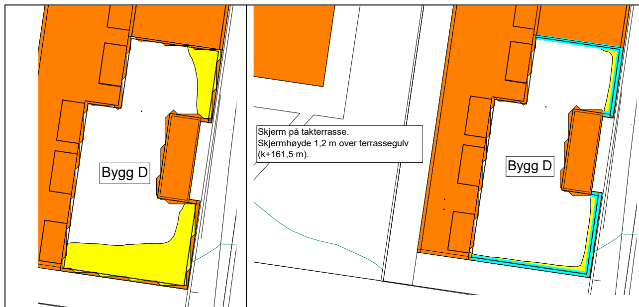
Figur 8 - Takterrasse bygg D. Beregnede støysoner L_{den} 1,5 m over terrassegulv. Uskjermert situasjon til venstre, skjermert situasjon i figur til høyre. Skjermen er vist med turkis farge og har høyde 1,2 m over terrassegulv.
