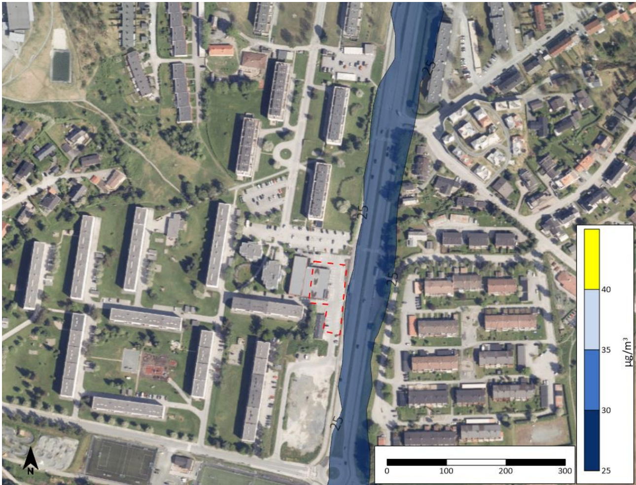
Figur 6: Luftsonekart som viser vintermiddelkonsentrasjon av \text{NO}_2 iht. gul sone i retningslinjen T-1520. Planområdet er markert med rødt. Konsentrasjonen av \text{NO}_2 i planområdet overskrider ikke grenseverdien.
