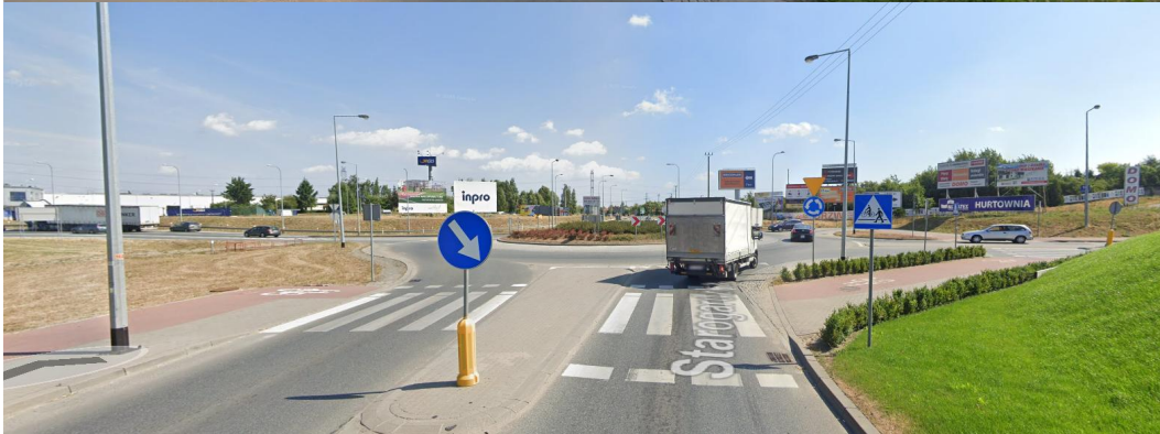
Skiltet som viser gangfelt og sykkelkryssing er plassert på høyre side i begge kjøreretninger.
