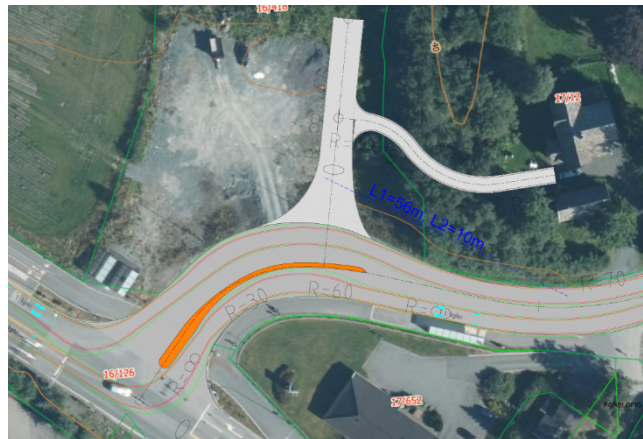
Figur 15: Vegløsning i kryss med økt lengde på midtdeler samt sporingsdiagram for buss
