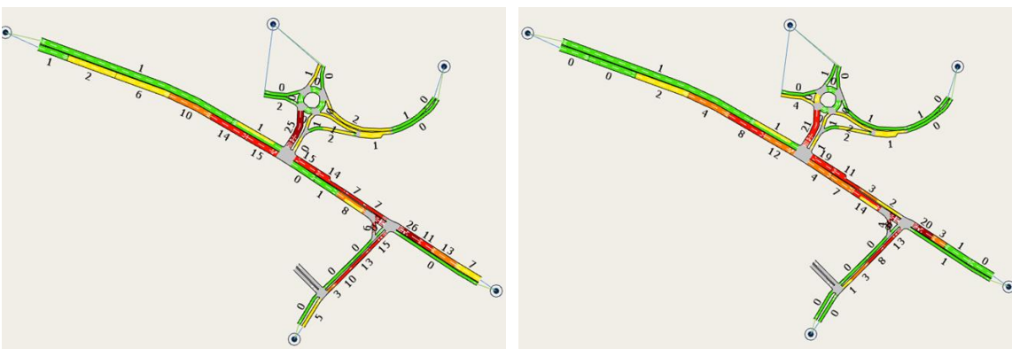
Figur 5-27: Simulert gjennomsnittlige forsinkelser (sek) i morgenrush og ettermiddagsrush. Følsomhetsanalyse der alle trafikstrømmer er økt med 10%.
