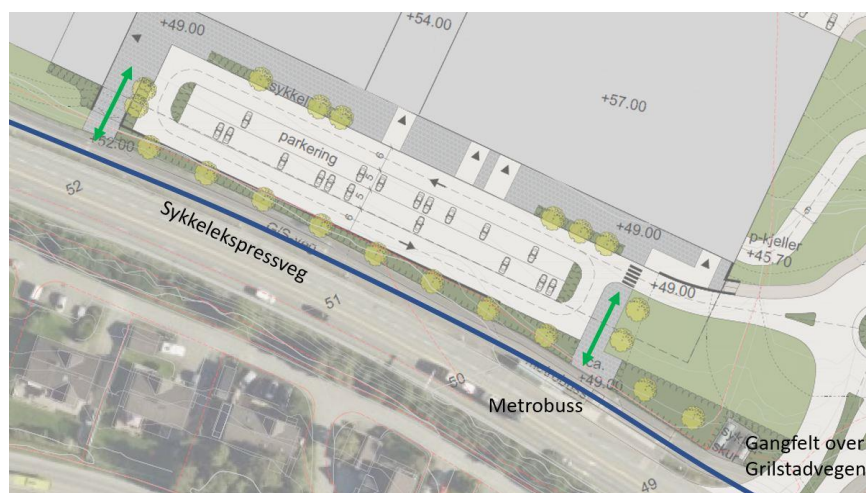
Figur 3-14: Utsnitt av foreløpig landskapsplan med sykkelekspressveg markert i blått og adkomster for myke trafikanter i grønt (Norconsult AS).
