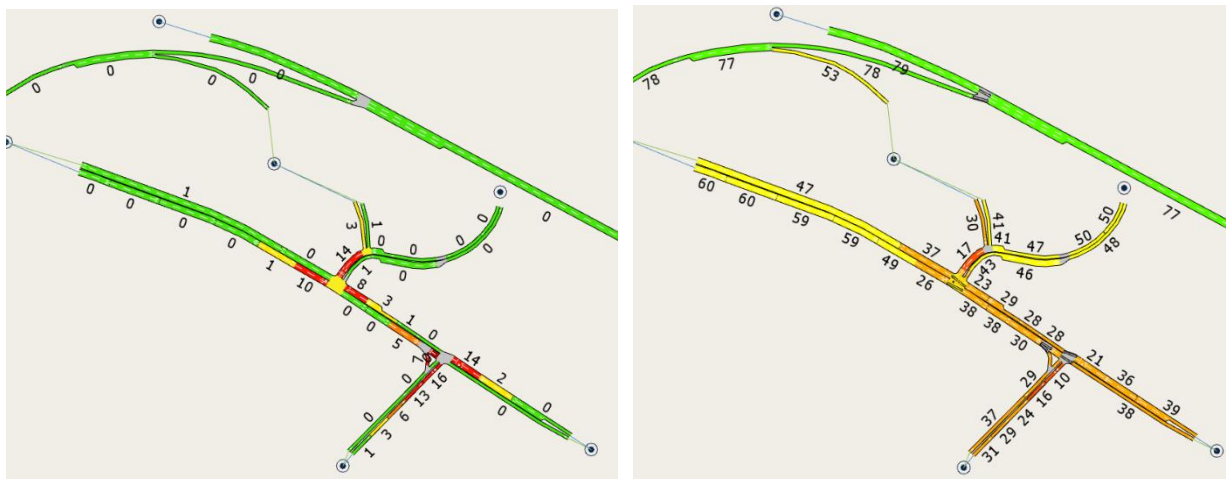
Figur 0.1: Simulert gjennomsnittlige forsinkelser (sek) og hastighet (km/t) i morgenrushet for alternativ 1b med framskrevet trafikk og tillegg for Covid-19, full utbygging av Svenskjordet og Brundalsforbindelsen.
