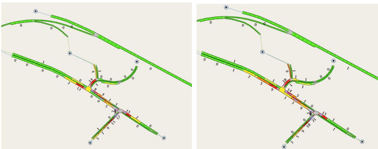
Figur 0.6: Simulert gjennomsnittlige forsinkelser (sek) i morgenrushet (venstre) og ettermiddagsrushet (høyre) for alternativ 1b med framskrevet trafikk og tillegg for Covid-19, full utbygging av Svenskjordet og Brundalsforbindelsen. Og en økning av alle trafikkmengder med 10%.
