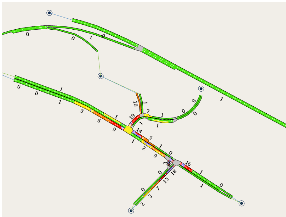
Figur 14: Simulert gjennomsnittlige forsinkelser (sek) i ettermiddagsrushet for alternativ 1b med framskrevet trafikk og tillegg for Covid-19, full utbygging av Svenskjordet og Brundalsforbindelsen. Og en økning av alle trafikkmengder med 20%. Her er det også tatt hensyn til redusert gjennomgangstrafikk i Kochhaugvegen som følge av ramper ved Overvik.
