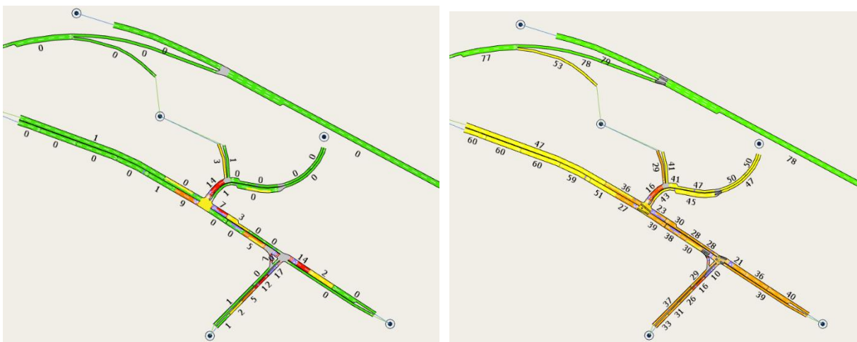
Figur 0.4: Simulert gjennomsnittlige forsinkelser (sek) og hastighet (km/t) i morgenrushet for alternativ 1b med kollektivprioritering for metabuss, framskrevet trafikk og tillegg for Covid-19, full utbygging av Svenskjordet og Brundalsforbindelsen.
