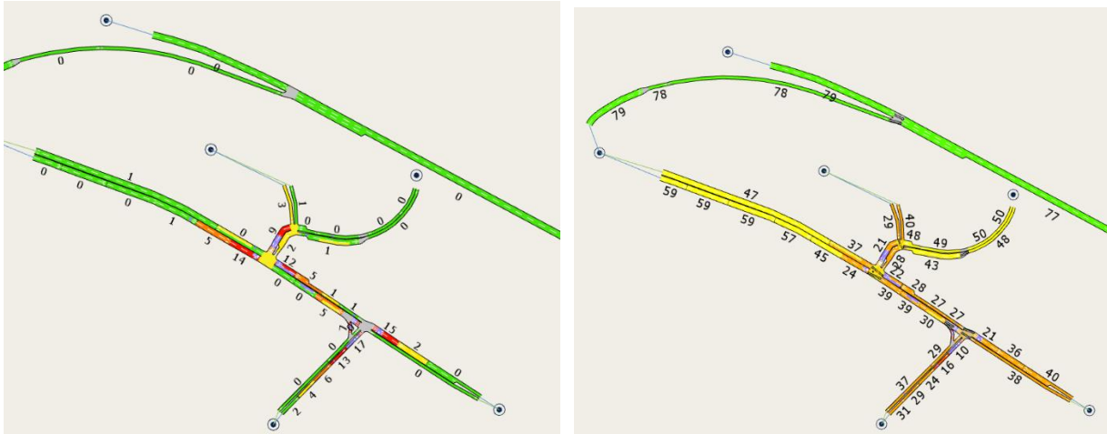
Figur 0.1: Simulert gjennomsnittlige forsinkelser (sek) og hastighet (km/t) i morgenrushet for alternativ 1a med framskrevet trafikk og tillegg for Covid-19, full utbygging av Svenskjordet og Brundalsforbindelsen.
