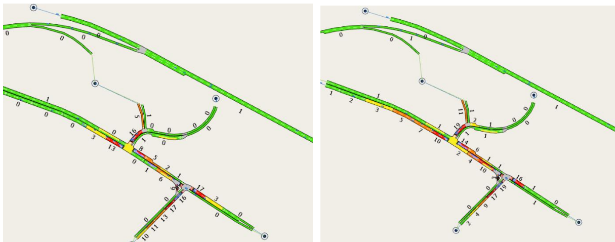
Figur 0.10: Simulert gjennomsnittlige forsinkelser (sek) i morgenerushet (venstre) og ettermiddagsrushet (høyre) for alternativ 1b med framskrevet trafikk og tillegg for Covid-19, full utbygging av Svenskjordet og Brundalsforbindelsen. Og en økning av alle trafikkmengder med 20% samt justerte faseplaner.
