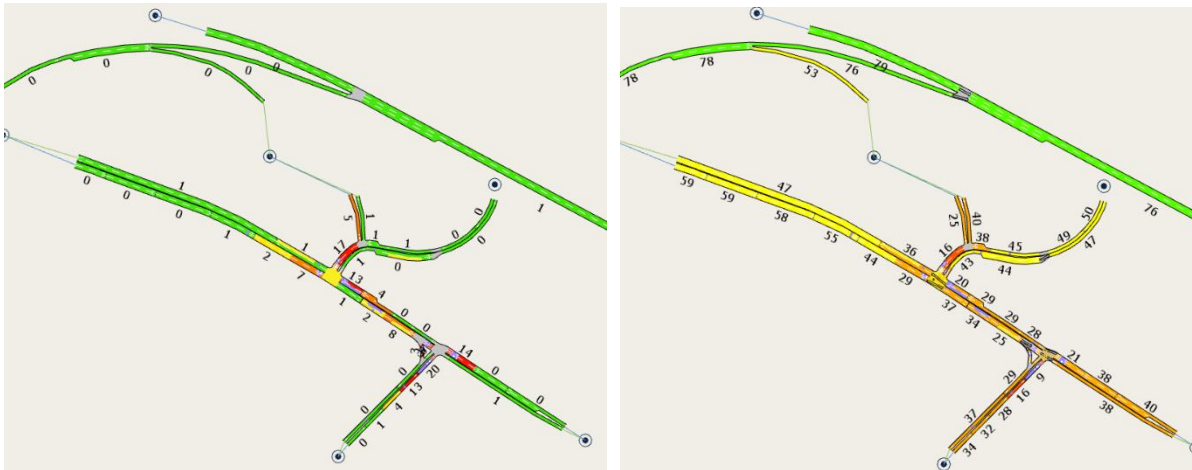
Figur 0.5: Simulert gjennomsnittlige forsinkelser (sek) og hastighet (km/t) i ettermiddagsrushet for alternativ 1b med kollektivprioritering for metrobuss, framskrevet trafikk og tillegg for Covid-19, full utbygging av Svenskjordet og Brundalsforbindelsen.
