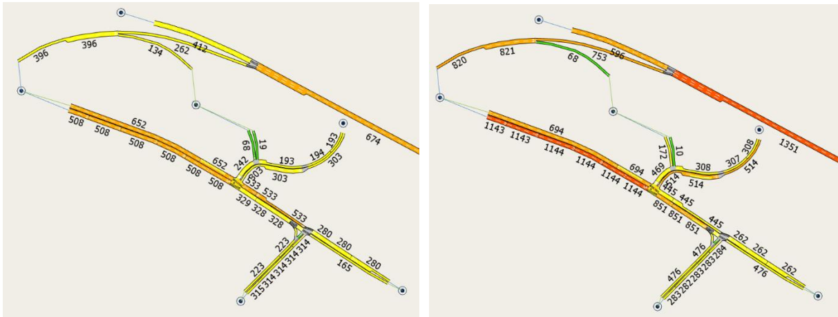
Figur 0.3: Simulert trafikkvolum (kj/t) for henholdsvis morgenrush og ettermiddagsrush for alternativ 1b med framskrevet trafikk og tillegg for Covid-19, full utbygging av Svenskjordet og Brundalsforbindelsen.
