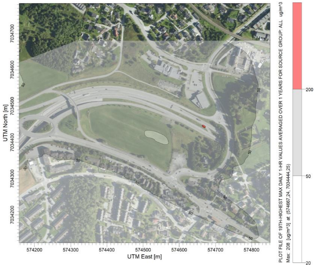
Figur 14: Luftsonkart NO 2 i henhold til grenseverdi for timesmiddel i forurensningsforskriften. Det er ingen overskridelser i planområdet, men noe ved tunnelportalen. Figuren viser 19. høyeste time siden det er tillatt med 18 overskridelser ıla et kalenderår.
