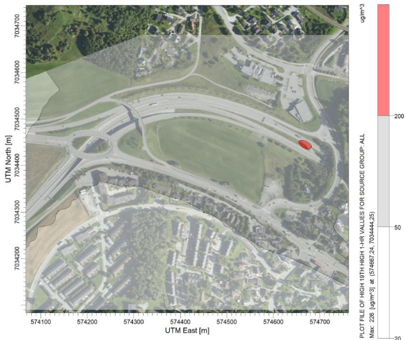
Figur 5: Luftsonekart NO 2 i henhold til grenseverdi for timesmiddel i forurensningsforskriften. Det er ingen overskridelser i planområdet, men noe ved tunnelportalen. Figuren viser 19. høyeste time siden det er tillatt med 18 overskridelser ila et kalenderår.
