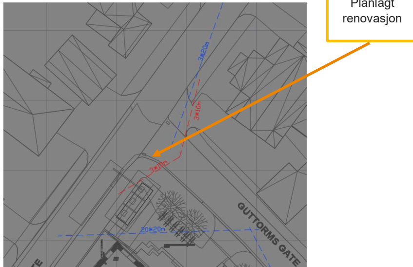
Figur 4: Blå stiplet linje viser siktlinje for kjørende og rød linje viser siktlinje mot fortau.
