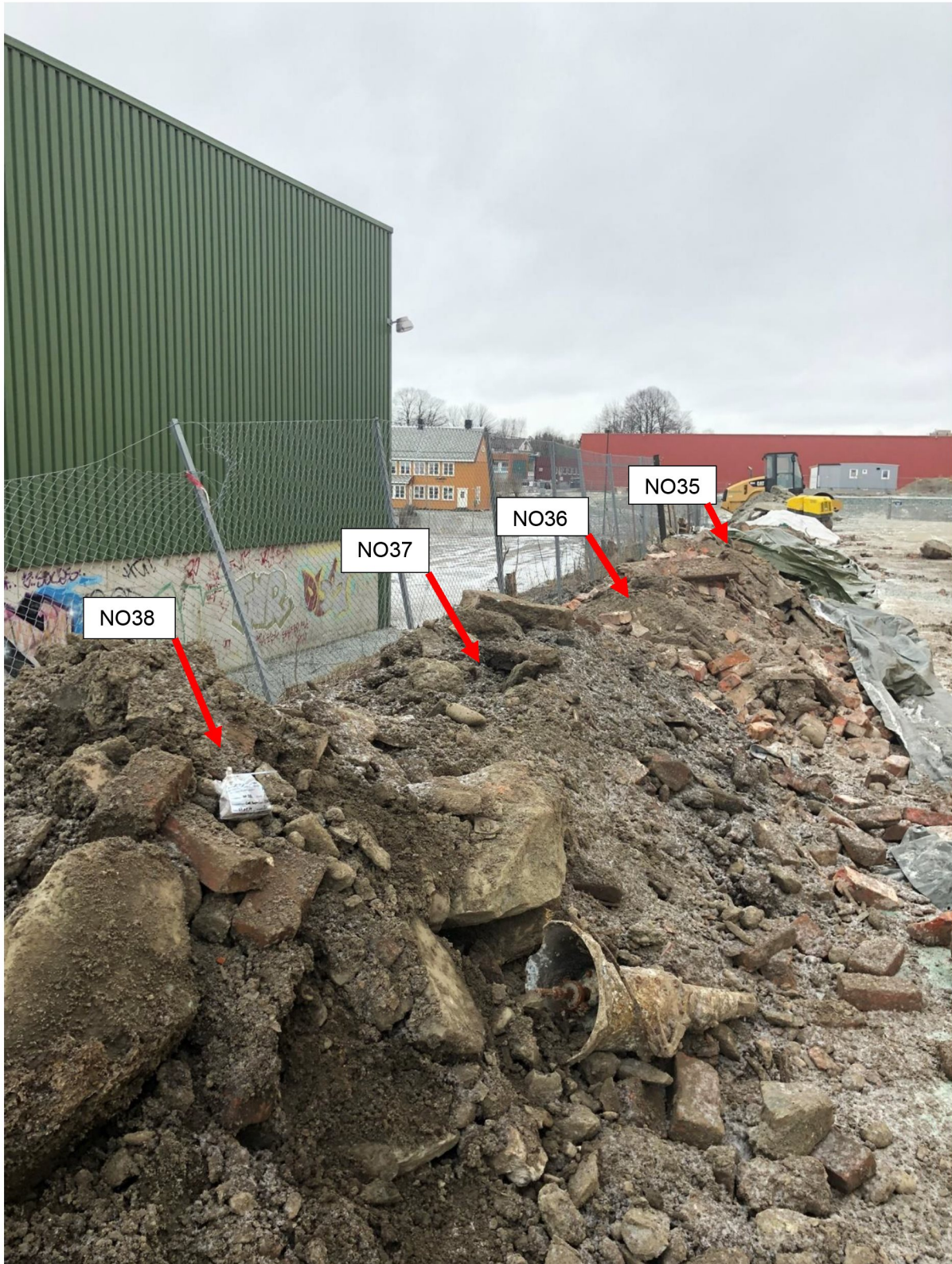
Figur 4: Prøvetaking av masser ved østlig VA-trasé. Oversikt over hvor jordprøvene ble tatt ut.
