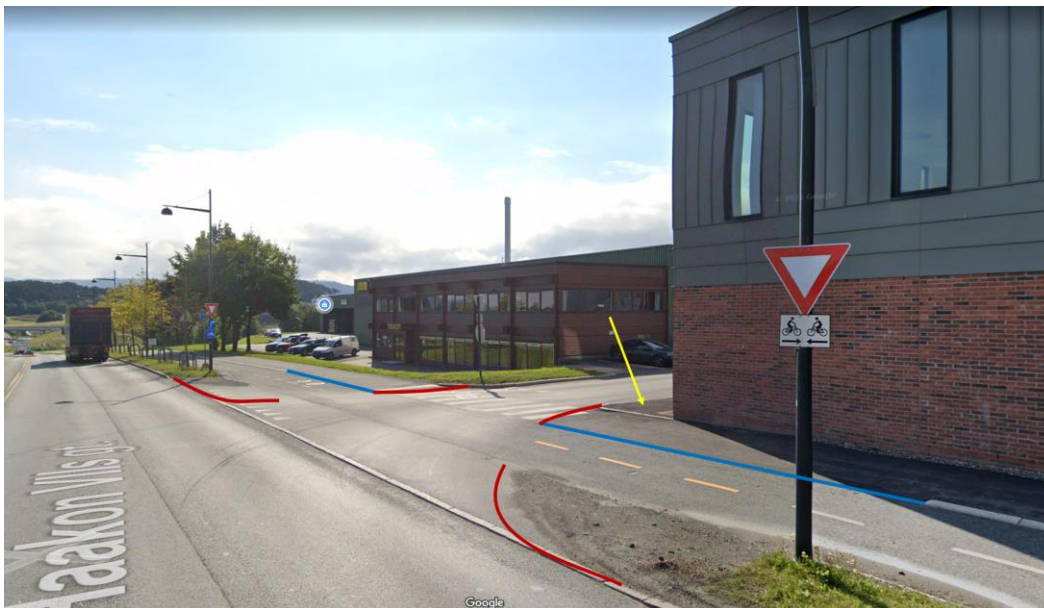
Figur 8-2: Forslag til tiltak som strammer opp krysset med bedre definert kjørebane og tydeligere skille mellom areal for gående og syklende og kjørende trafikk.
