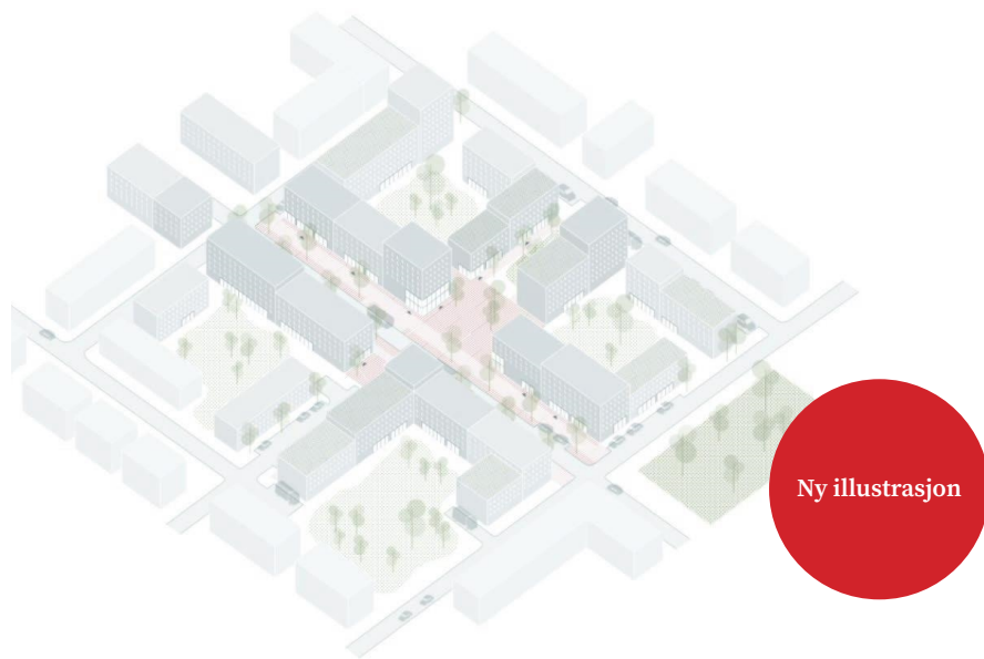
Figur 12. Ofte må fotgjengere forsere store parkeringsplasser for å komme til butikker og annen service. Plassering av butikken inntil hovedåren og parkeringsplasser ved siden av butikken, gir kortere avstander for fotgjengere. Ikke minst bidrar plasseringen inntil fortauet til at gaterommet får en god form.
