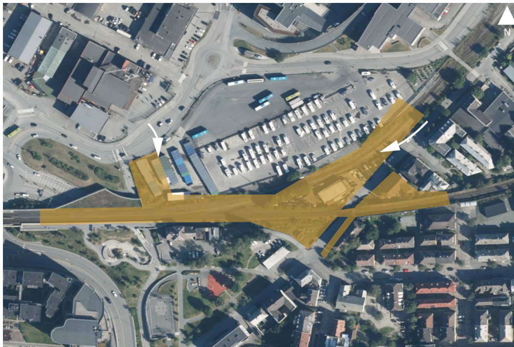
Foreløpig riggplan med riggområder markert i brunt, og hvite piler for adkomster til anlegget.
