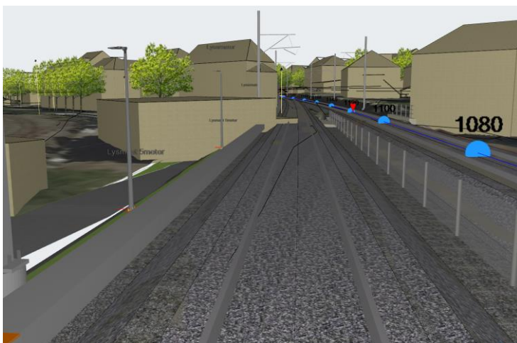
Figur 12 Sikt fra plattform mot signal i innerkurver ved Strandveien 23
