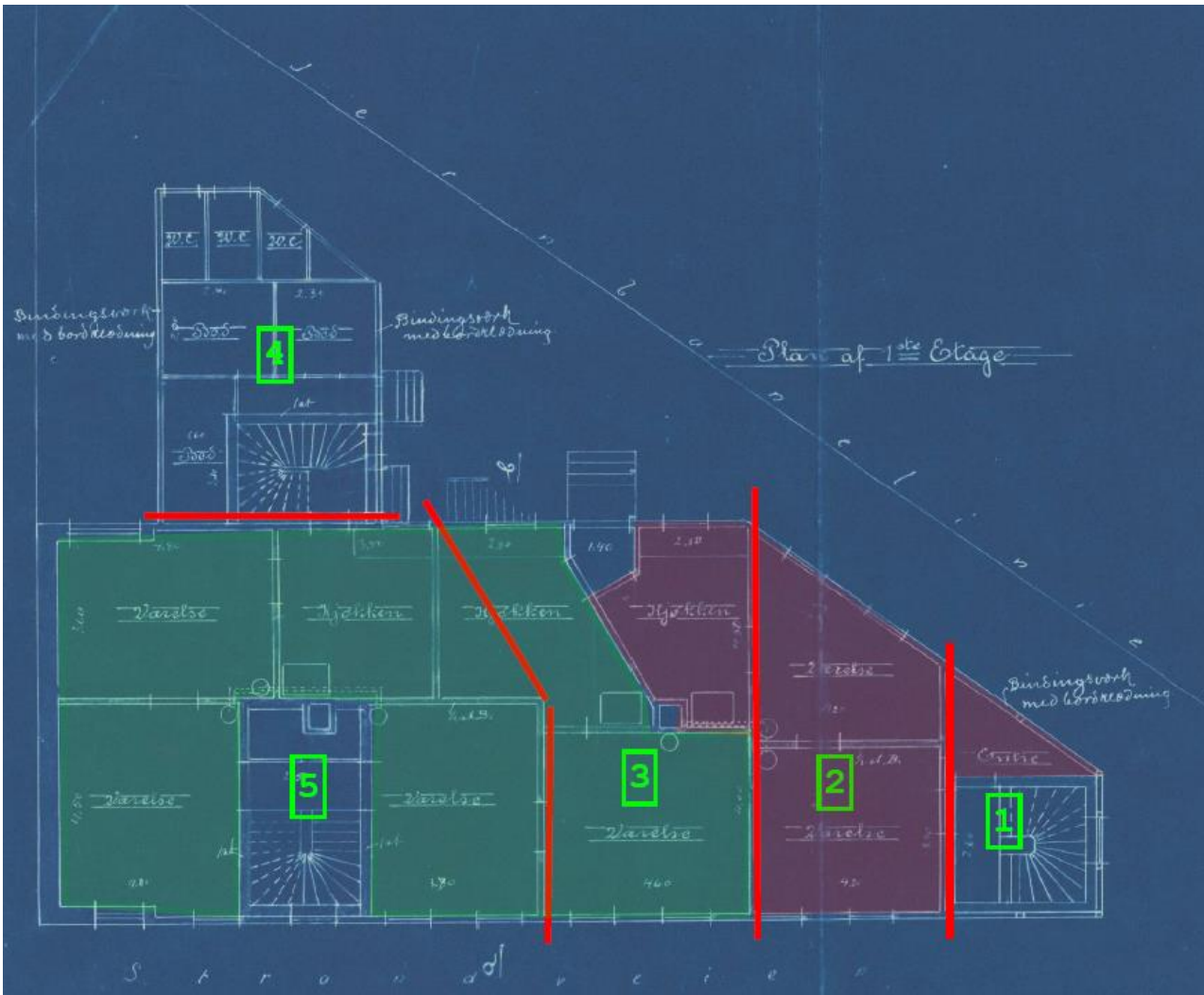
Figur 4: Skisse med forslag til oppdeling av 1. etasje av Strandveien 23. Se vedlegg 2 for hele bygget.
