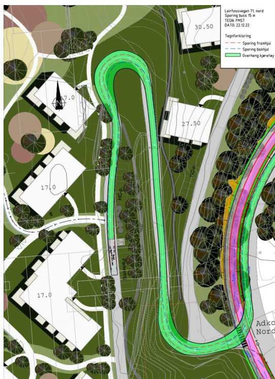
Figur 56 Spring avfallskjøretøy adkomstveg nord
