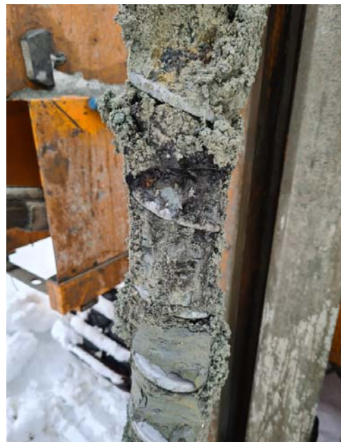
Figur 18: SK1 1-2 meter. Sand og grus over sjikt med gammel matjord over antatt original leire. Foto: Multiconsult.
