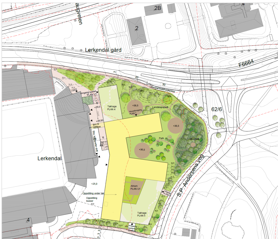
Figur 1-7 Illustrasjonsplanen viser Lerkendal Øst med bruk av oppbygde voller og vegetasjonsskjermer. Tegning: Norconsult illustrasjonsplan, versjon E02
