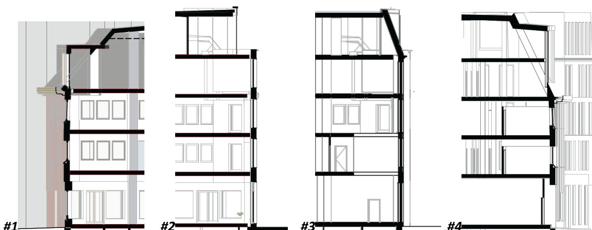
Takform og plassering av gesims mot gate er sikret i bestemmelsene innenfor bestemmelsesområdene #1-#4.
