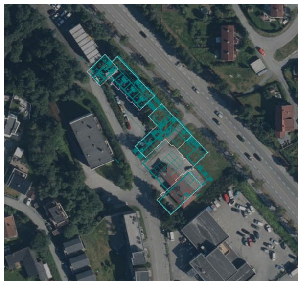
Figur 1-1 Oversiktskart og utsnitt av ortofoto med tomte, med ca. plassering av bygg i hvitt og forslag til utbredelse av parkeringskjeller markert med blått. Lokalstabilitet for utgraving for kjeller må ivaretas gjennom geoteknisk prosjektering.
