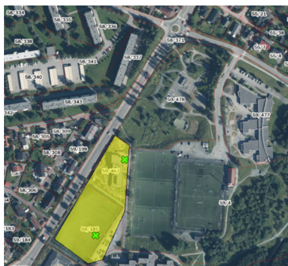
Gult område viser hvor det tidligere er registrert forurenset grunn.
