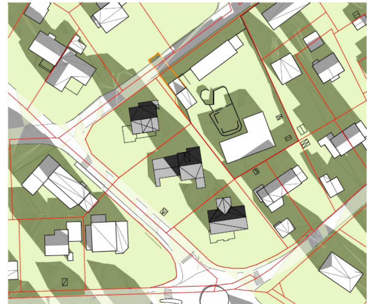
Eksisterende bygg 21. februar kl 10.00
