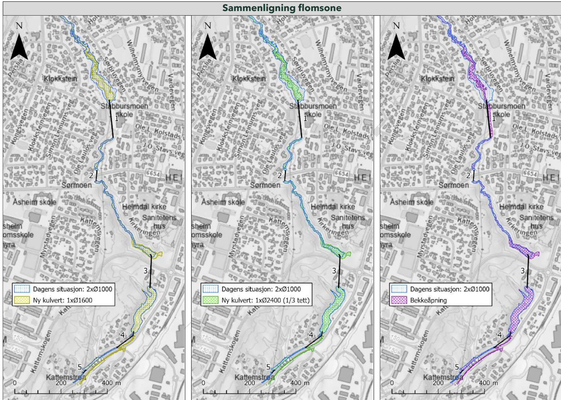
Figur 7-5. Sammenligning mellom flomsone for dagens situasjon, og situasjon med tiltak, ved 200-årsflom inkl. 40% klimapåslag.
