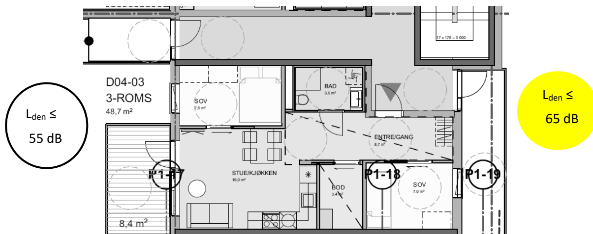
Figur 7 - Eksempel på planløsning som tilfredsstiller foreslåtte krav til støyutsatt enhet i øvre del av gul støysoner.
