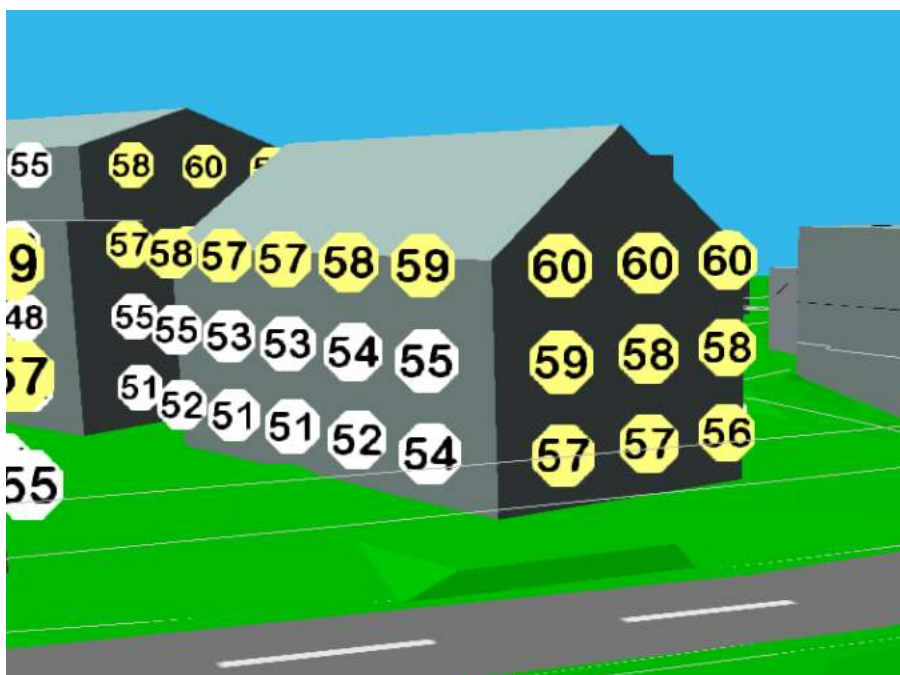
Figur 8 - Ekvivalent støynivå, L_{den} , på fasade av B03 uten skjermende tiltak sett fra sør.
