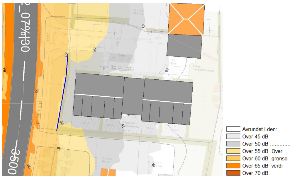
Figur 4 – Beregnet lydnivå ( L_{den} ) i 1,5 meters høyde over terreng. Støyskjerm i 1,5 m høyde er vist med blå strek.
