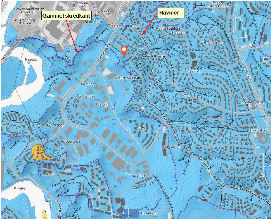
Figur 4.1 Kvartærgeologisk kart med markering av tidligere skredkanter og raviner. tomten er vist med rød markør.
