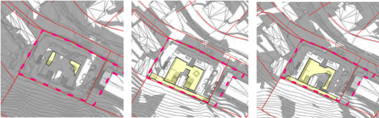
Illustrasjonene viser sol- skyggeforhold for planområdet hhv. 12 mars kl 12:00 og 23. juni kl. 15:00 og juni kl 18:00. Gulmarkering viser solbelyst planlagt felles uteoppholdsareal.
