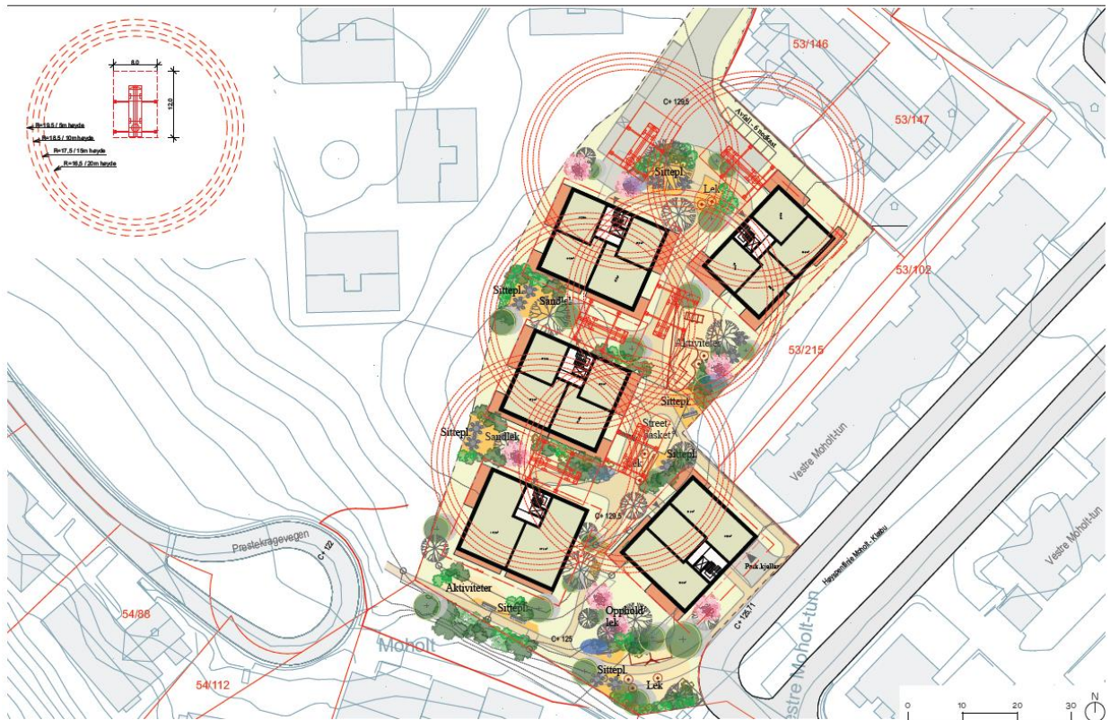
Figur 7. Prinsipp for brann og redning som kan håndteres fra den siden av bebyggelsen som ikke vender ut mot høyspentlinjen – for alle boligenhetene. Fra illustrasjonsvedlegg PIR2.
