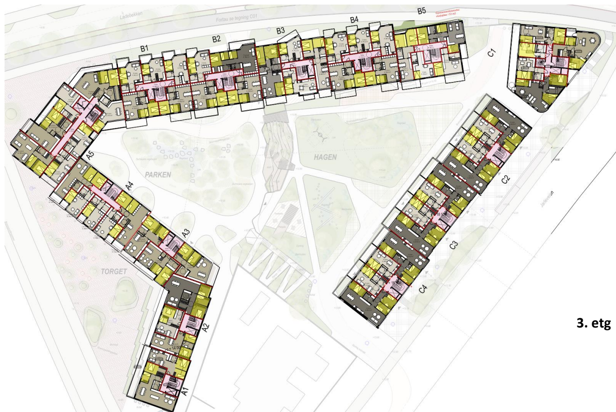
Figur 4 - Eksempel på planløsning for alle byggene, med soverom markert med gult. Rød stiptet strek markerer leilighetsskille rundt boenheter.
