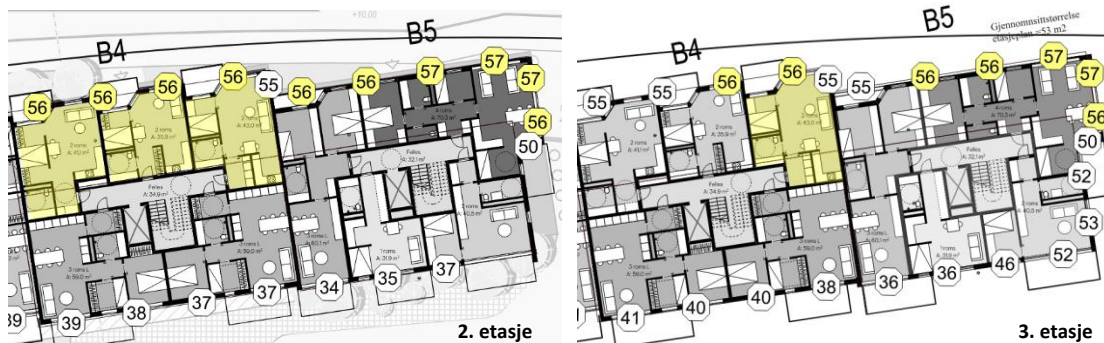
Figur 12 - Boenheter på plan 2 og 3 i B4 uten fasade med tilfredsstillende støynivå uten tiltak (gult markerer boenhet med behov for dempet fasade i form av tett rekkverk på balkong og absorpent i dekket over balkong).
