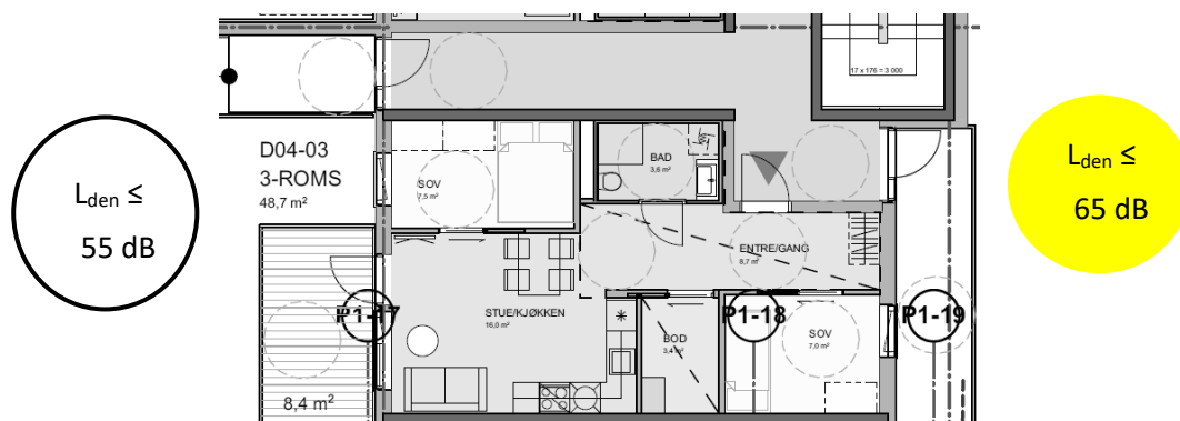
Figur 6 - Eksempel på planløsning som tilfredsstiller foreslåtte krav til bebyggelse i gul støysone.
