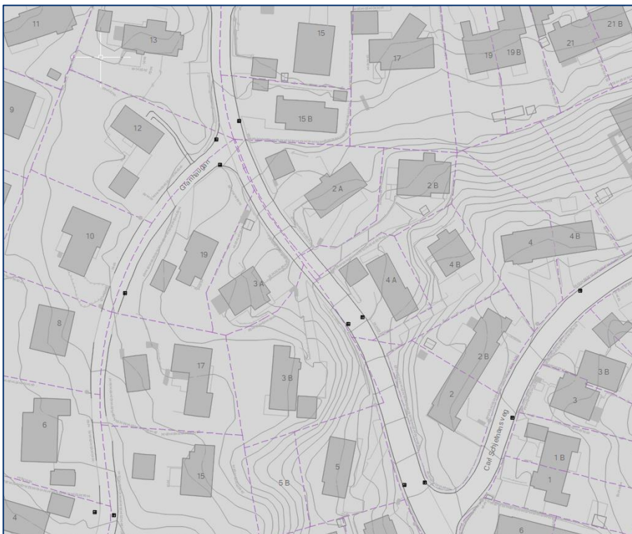
Figur 11: Eksisterende sluk i Mikkelvegen
