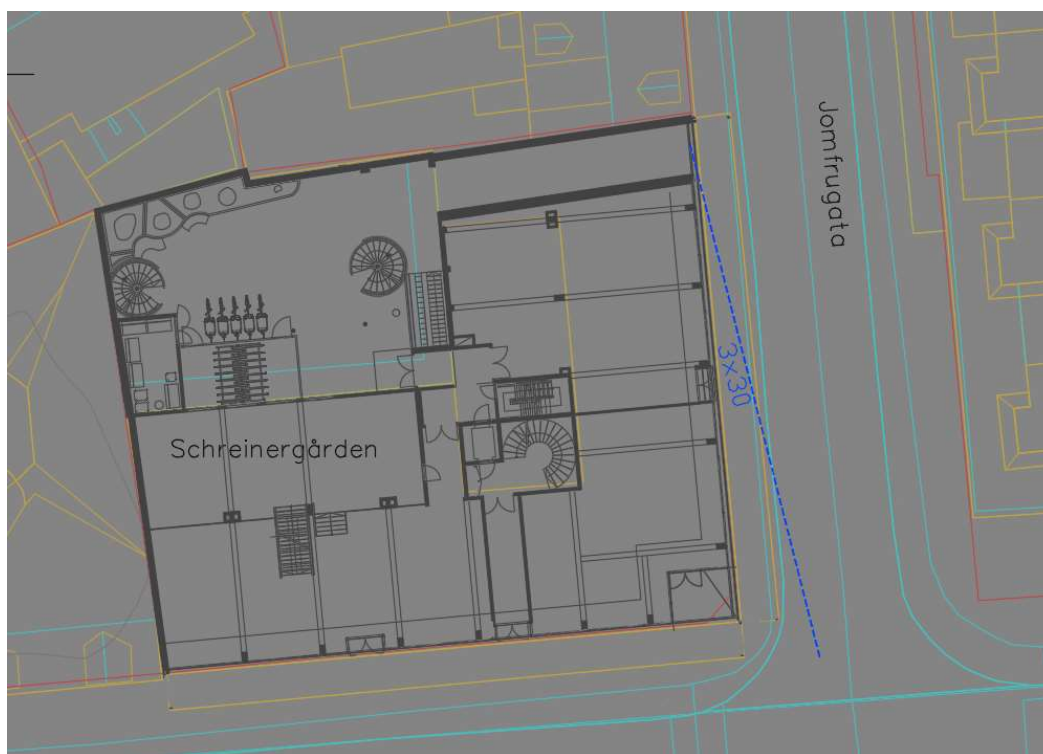
Figur 6 Siktretkant mot kjørebane.
