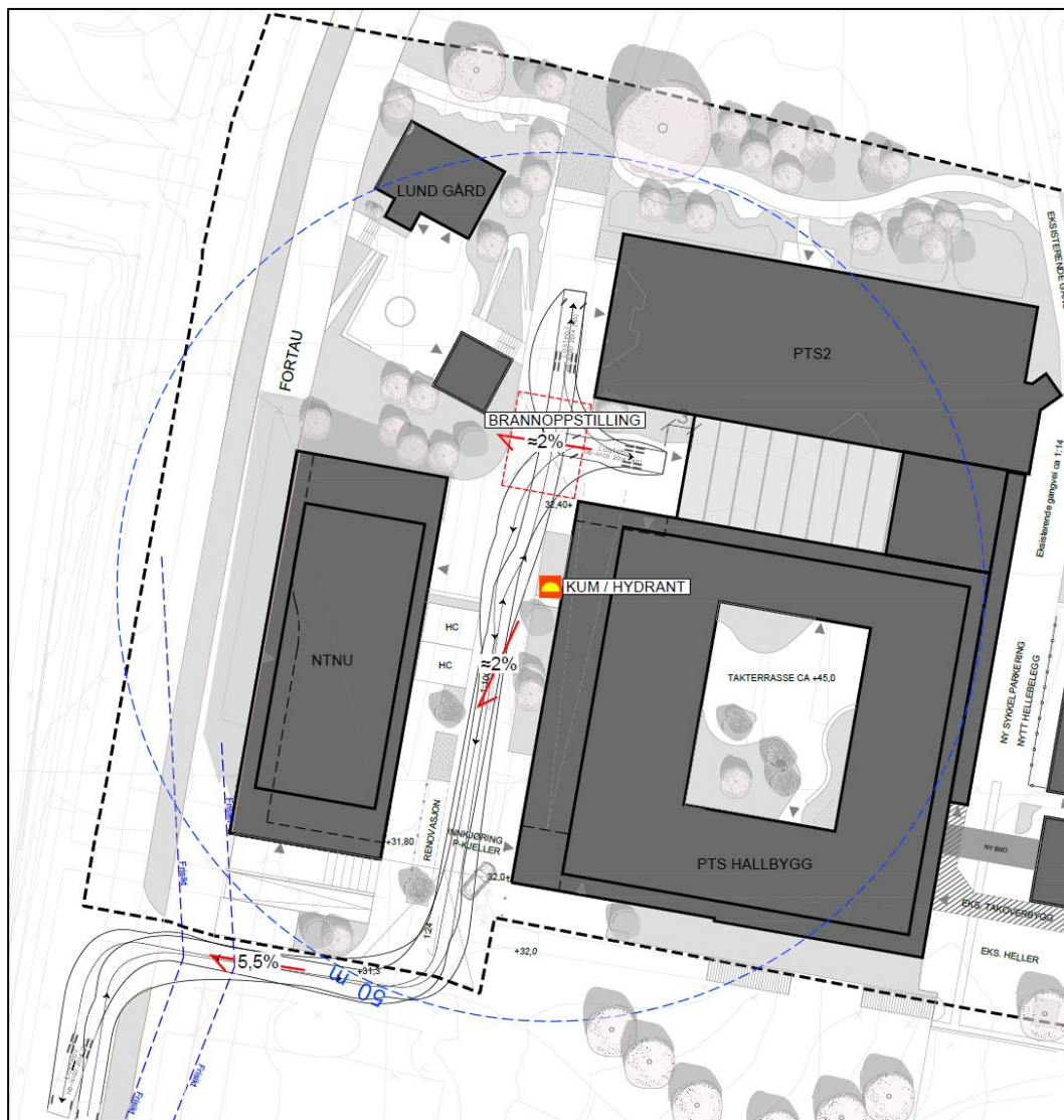
Figur 16 Sporingsskurver, brannoppstilling og brannkum
