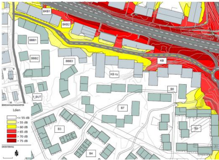
Figur 8 Støy i høyde (1,5 meter over terreng) for uteareal etter utvidelse av planområdet. Utklipp fra vedlagte tegning
