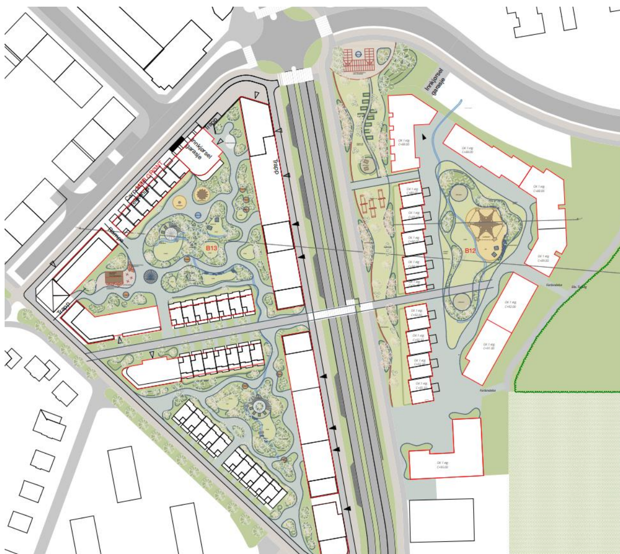
BILDE 4: OVERVANNSLØSNINGER (TRINN 1) SOM FORELØPIG PLANLAGT AV LANDSKAPSARKITEKT
