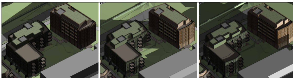
Illustrasjonene viser sol-/skyggeforhold på bygg sett fra nordvest 21. mars kl. 12, 15 og 17
