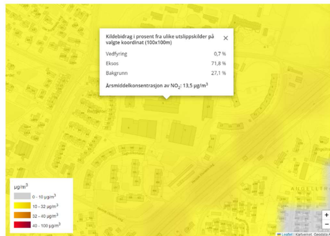
Figur 5: Utlipp av kart som viser årsmiddelkonsentrasjon av PM10 (til venstre) og årsmiddelkonsentrasjon av NO 2 (til høyre) ved Brøsetekra 5, 7 og 13, hentet fra fagbrukertjenesten for luftforurensning [10]. Konsentrasjonen av PM10 på 9,6 µg/m 3 er godt under grenseverdien i forurensningsforskriften på 20 µg/m 3 og anbefalte luftkvalitetskriterier på 15 µg/m 3 .
