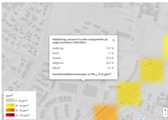
Figur 6: Utlipp av kart som viser korttidsmiddelkonsentrasjon av PM10 (til venstre) og NO 2 (til høyre) ved Brøsetekra 5, 7 og 13 hentet fra fagbrukertjenesten for luftforurensning [10]. Konsentrasjonen av PM10 på 21,8 µg/m 3 er under grenseverdien i forurensningsforskriften på 50 µg/m 3 . Konsentrasjonen av NO 2 , 79,8 µg/m 3 er under grenseverdien i forurensningsforskriften på 200 µg/m 3 . Korttidsmiddel for PM10 viser 26 høyeste døgn med 25 tillatte overskridelser ila ett kalenderår. For NO 2 vises 19 høyeste døgn siden det er tillatt med 18 overskridelser ila ett kalenderår.
