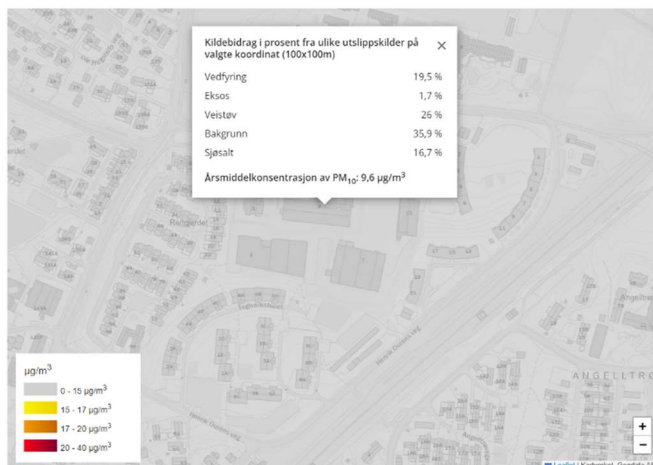
Figur 5: Utlipp av kart som viser årsmiddelkonsentrasjon av PM10 (til venstre) og årsmiddelkonsentrasjon av NO 2 (til høyre) ved Brøsetekra 5, 7 og 13, hentet fra fagbrukertjenesten for luftforurensning [10]. Konsentrasjonen av PM10 på 9,6 µg/m 3 er godt under grenseverdien i forurensningsforskriften på 20 µg/m 3 og anbefalte luftkvalitetskriterier på 15 µg/m 3 .
