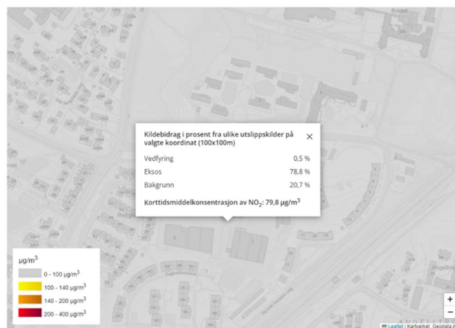
Figur 6: Utlipp av kart som viser korttidsmiddelkonsentrasjon av PM10 (til venstre) og NO 2 (til høyre) ved Brøsetekra 5, 7 og 13 hentet fra fagbrukertjenesten for luftforurensning [10]. Konsentrasjonen av PM10 på 21,8 µg/m 3 er under grenseverdien i forurensningsforskriften på 50 µg/m 3 . Konsentrasjonen av NO 2 , 79,8 µg/m 3 er under grenseverdien i forurensningsforskriften på 200 µg/m 3 . Korttidsmiddel for PM10 viser 26 høyeste døgn med 25 tillatte overskridelser ila ett kalenderår. For NO 2 vises 19 høyeste døgn siden det er tillatt med 18 overskridelser ila ett kalenderår.
