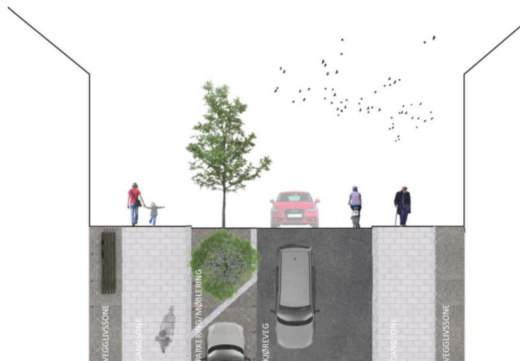
Figur 19 Materialsnitt som viser utforming av parkeringslomme med storgatestein. Illustrasjon utarbeidet av Asplan Viak.
