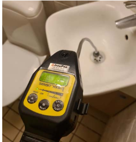
Figur 17: Måling med Sensit HXG-3 i vask på bad i kjeller. Foto: Multiconsult.
