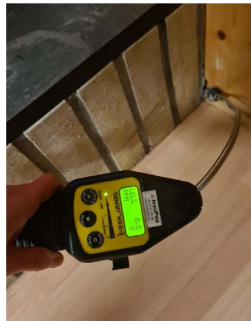
Figur 19: Måling langs gulvlist kjeller. Foto: Multiconsult.
