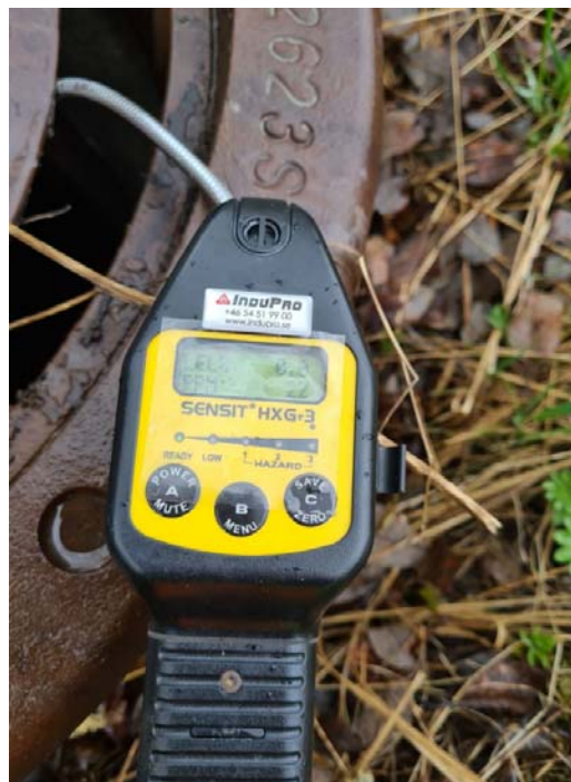
Figur 21: Måling i kum for AF-ledning.
