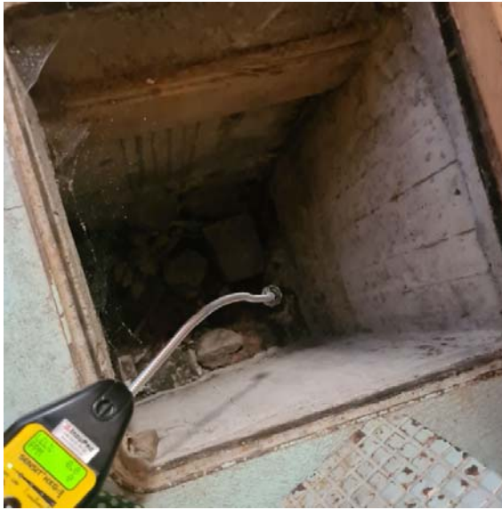
Figur 16: Måling med Sensit HXG-3 i stakepunkt i kjeller. Foto: Multiconsult.
