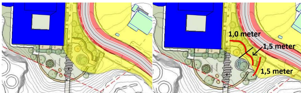
Figur 3-4 Støysonekart 1,5 meter over terreng. T.v.: uten støyskjermer, t.h.: med støyskjermer
