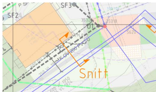
FIGUR 7 Plassering av snitt OV parallelt med vannledninger
