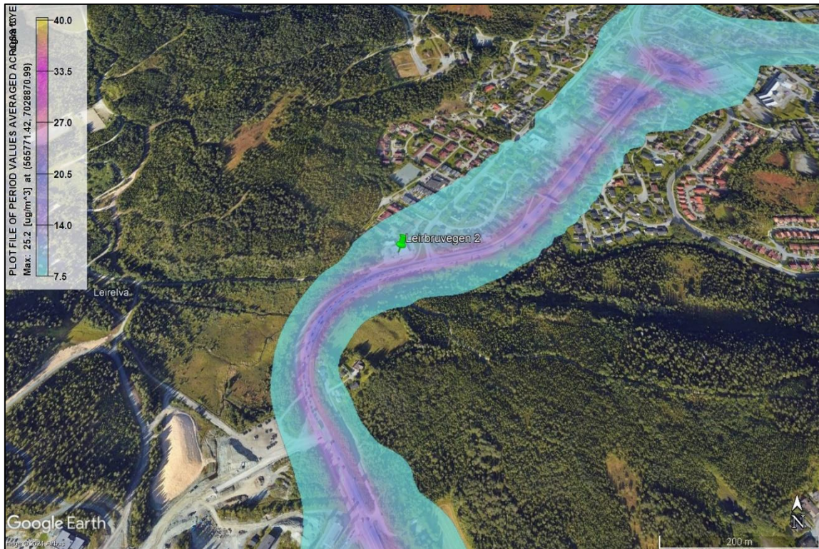
Figur 4-2: Konsentrasjonsutbredelse representert ved NO 2 vintermiddel (µg/m 3 ) for dagens situasjon (2022). Gul sone inntreffer ved 40 µg/m 3 . Spredningskartet er presentert i Google Earth.
