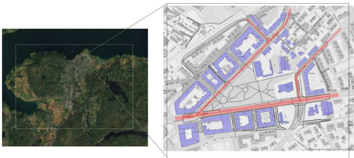
Figur 6. Oversikt over modellområdet for Voldsminde brukt i spredningsmodelleringen. Beregningsområdet for GRAMM er markert med rektangel på ortofotoet til venstre, og for GRAL til høyre. GRAL-illustrasjonen viser bygninger (lilla) og veg-utslippskilder (røde) i modellen markert.
