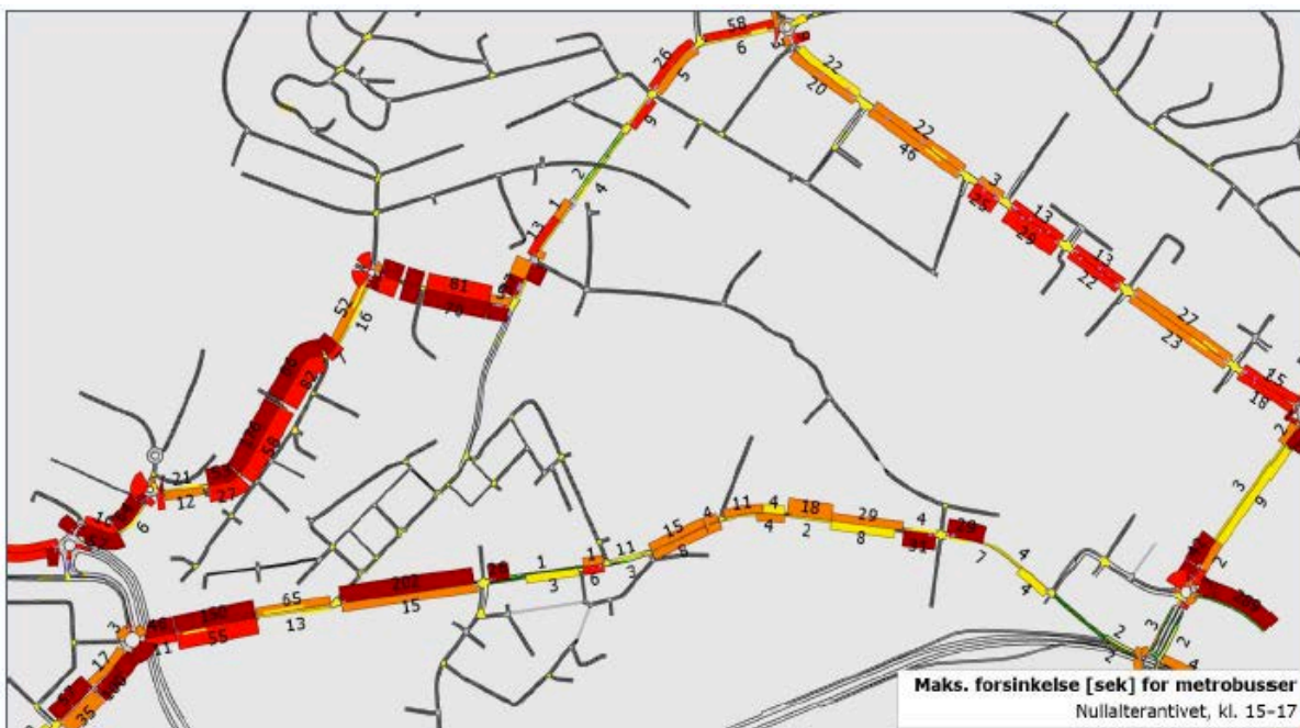
Figur 16: Maks forsinkelser i ettermiddagsrush for metrobuss line 1 og 2 i Dyre Halses gate, Maskinistgata, Stiklestadveien, Jarleveien, Haakon VII's gate, Bromstadvegen og Innherredsveien, modellert framtidig situasjon med utbygging av boliger, uten fysiske endringer i vegsystemet
