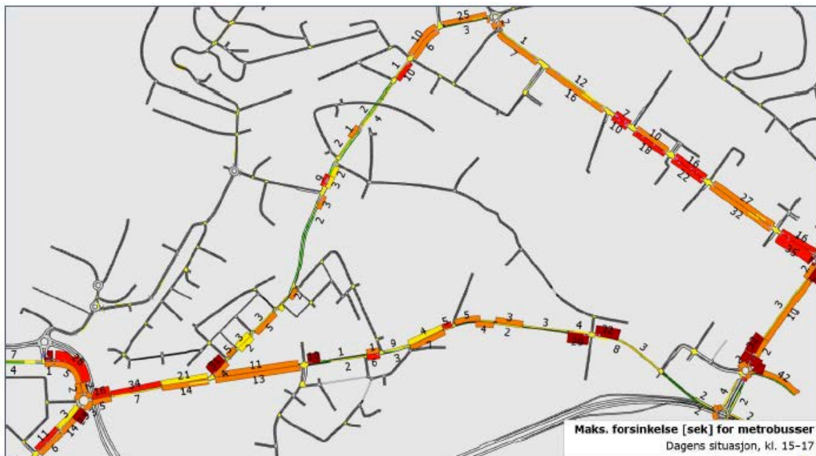
Figur 15: Maks forsinkelser i ettermiddagsrush for metrobuss linje 1 og 2 i Dyre Halses gate, Innherredsveien, Mellomveien, Jarleveien, Haakon VII's gate og Bromstadvegen, modellert nåsituasjon
