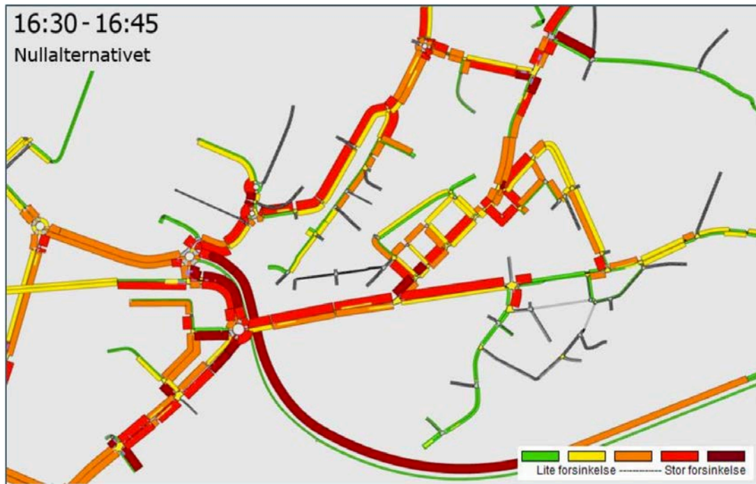
Figur 20: Forsinkelsesplott for det mest belastede kvarter om ettermiddagen i nullalternativet
