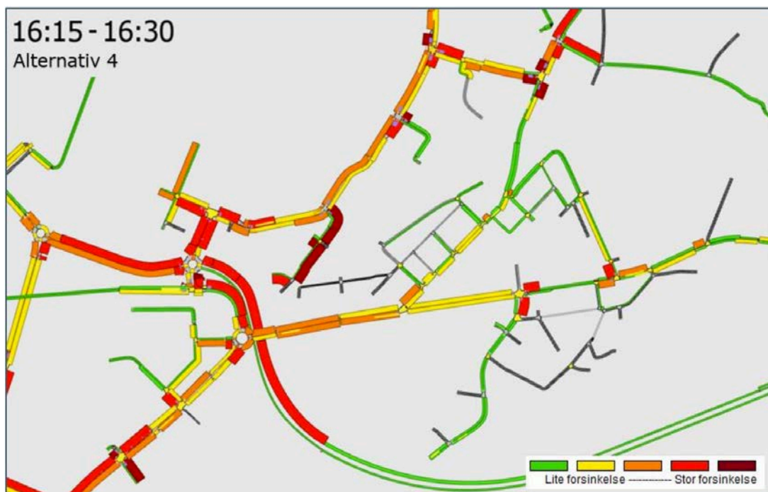
Figur 21: Forsinkelsesplott for det mest belastede kvarter om ettermiddagen i alternativ 4
