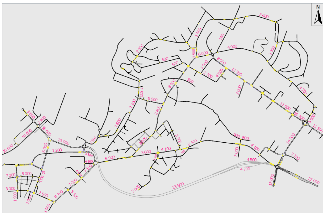
Figur 2-1: Dagens ÅDT [kjt/døgn] basert på verdier fra NVDB for 2021 og 2022
