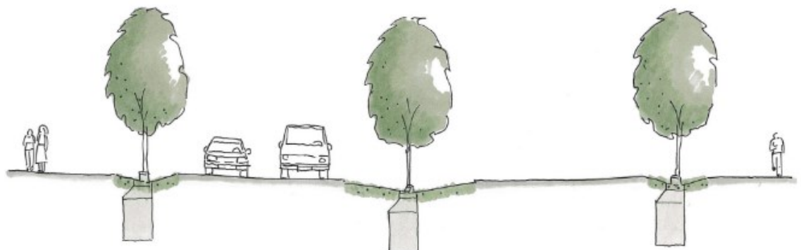
Figur 7.2-4: Prinsipp gateprofil med infiltrasjon i siderabatter. (Laukli, 2017)
