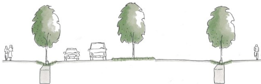
Figur 7.2-4: Prinsipp gateprofil med infiltrasjon i siderabatter. (Laukli, 2017)
